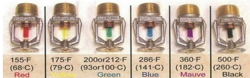
อุณหภูมิทำงานของหัวกระจายน้ำดับเพลิง
